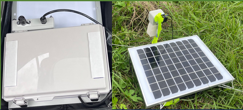
図2. ストリーミングデバイス（wavelogy株式会社 開発） スマートフォンでリアルタイムの音を聞くことができる。 ソーラー充電で、SDカード・電池交換の必要がない。
